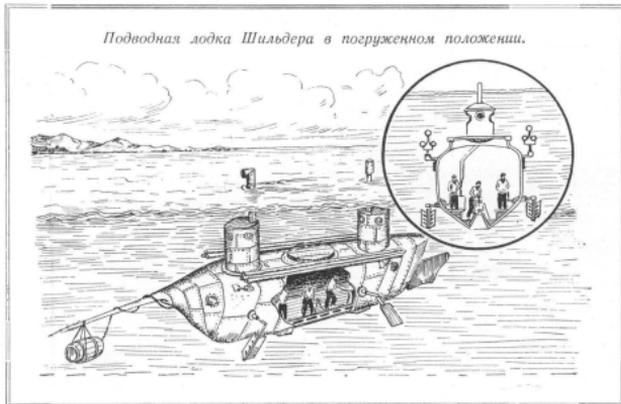
всплывать. В передней части судна находились небольшие башенки для управления погружением и для осмотра горизонта через устроенные в них иллюминаторы.
